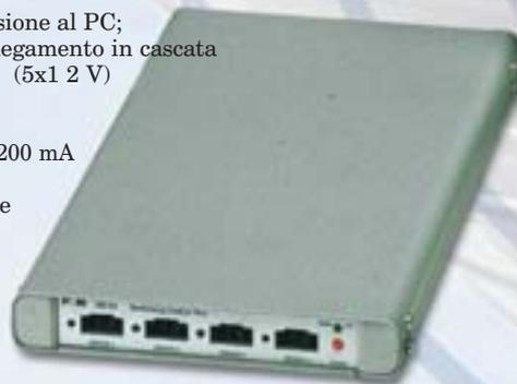
Il controllore automatico PMM SB-04, è un accessorio versatile ed espandibile per monitorare contemporaneamente campi elettrici e magnetici da 5 Hz a 40 GHz. Con il modulo GPS è anche possibile misurare ed archiviare la posizione del sistema. Il PMM SB-04 supporta sia il PMM 8053A che tutte le sue sonde equipaggiate con il ripetitore ottico OR-02/OR-03 e le EHP50A/B/C.
