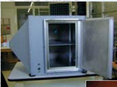
Nella gamma di frequenza da 5 Hz a 400 MHz le tarature dei sensori vengono eseguite in celle TEM (Transverse Electro Magnetic) in cui il campo elettromagnetico presenta le caratteristiche di spazio libero.
