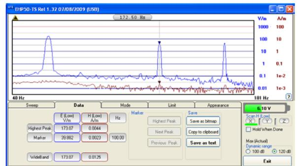
L'analisi di spettro di entrambi i campi, elettrico e magnetico, può essere visualizzata sullo stesso grafico
