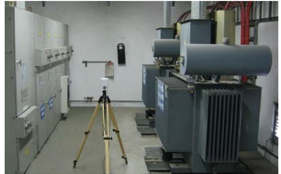
Misura del campo magnetico in prossimità di trasformatori.
