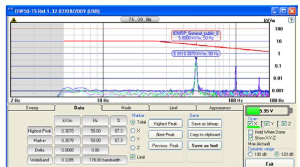
E' possibile visualizzare il valore del limite alla frequenza del marker. La sezione "Data" mostra i risultati numerici ed include controlli per il posizionamento del marker e la memorizzazione dei risultati.
